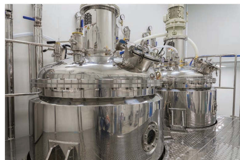
Ukázka využití leštěného povrchu nerezové oceli v potravinářství
